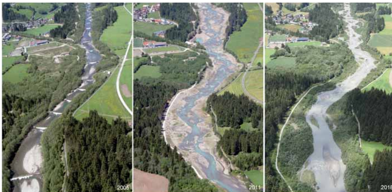
Der Mareiter Bach bei Stange, vor (2005) und nach (2011, 2018) Umsetzung der Revitalisierungsmaßnahmen. Das Flussbett wurde aufgeweitet, die Durchgängigkeit wieder hergestellt, 6 ha vitaler Auwald zurückgewonnen.
